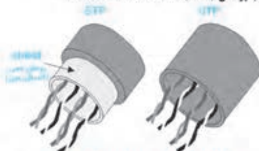
شکل (۱۳-۳) انواع کابل‌های زوج به هم تابیده
