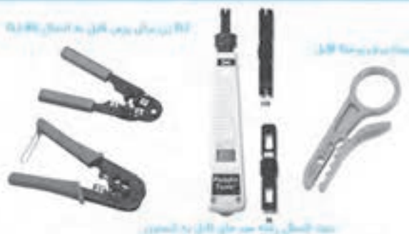
شکل (۳-۲۰) دستگاههای لازم برای نصب اتصالات RJ45
