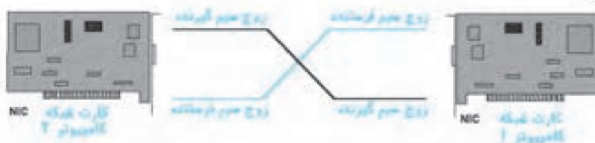
شکل (۳-۱۷) اتصال مستقیم دو رایانه با کابل UTP
