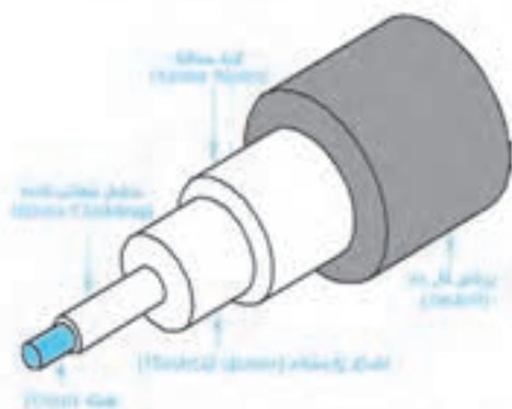
شکل (۳-۲۲) ساختار کابل فیبرنوری
